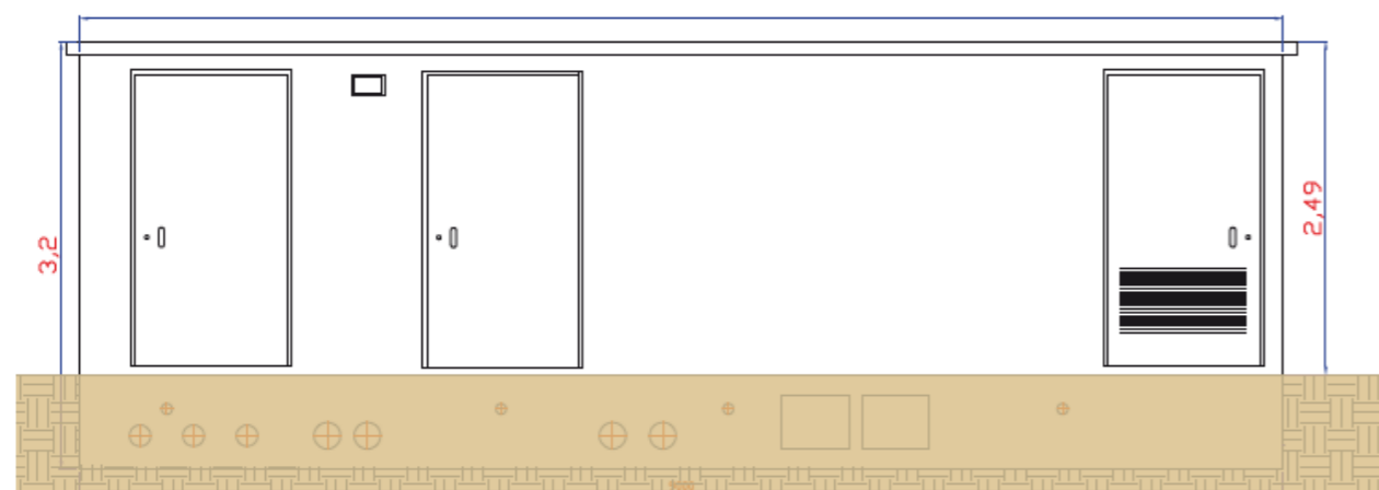
Figure 5 : Poste de livraison (Source Quénéa'ch)
