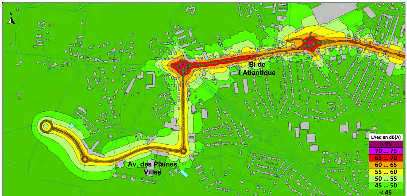
Figure 8 : Niveaux sonores à 4 m de hauteur - Situation projet 2050 - Période diurne (6h - 22h) - Zone Ouest 1
