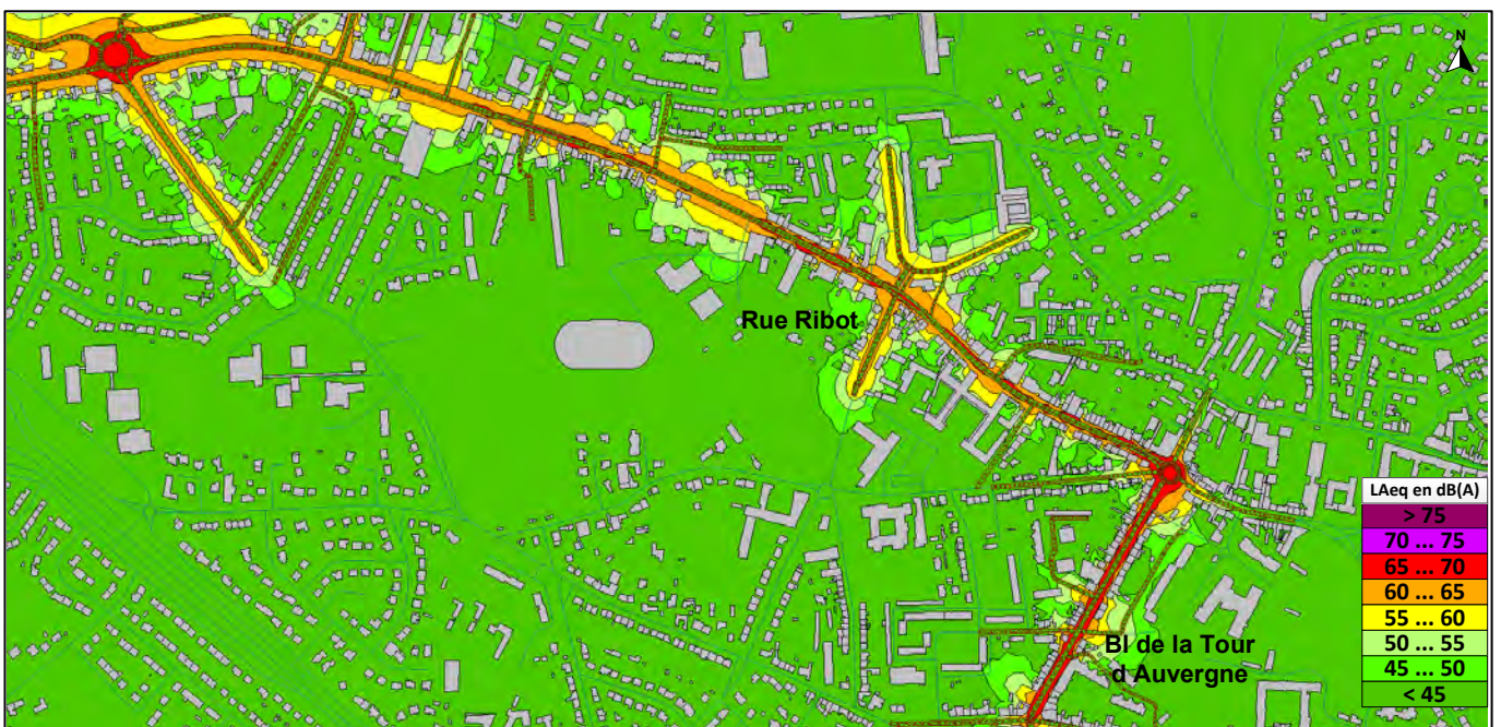
Figure 4 : Niveaux sonores à 4 m de hauteur - Situation initiale - Période diurne (6h - 22h) - Zone Ouest 2
