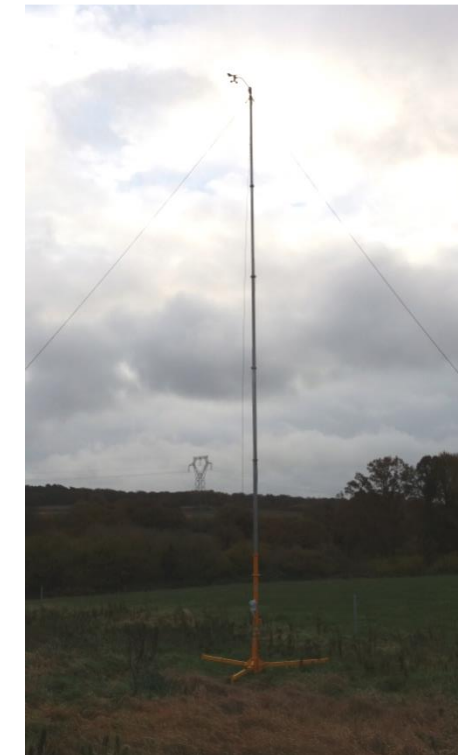
Photographie du mât de mesures météorologiques à 10 m de hauteur
