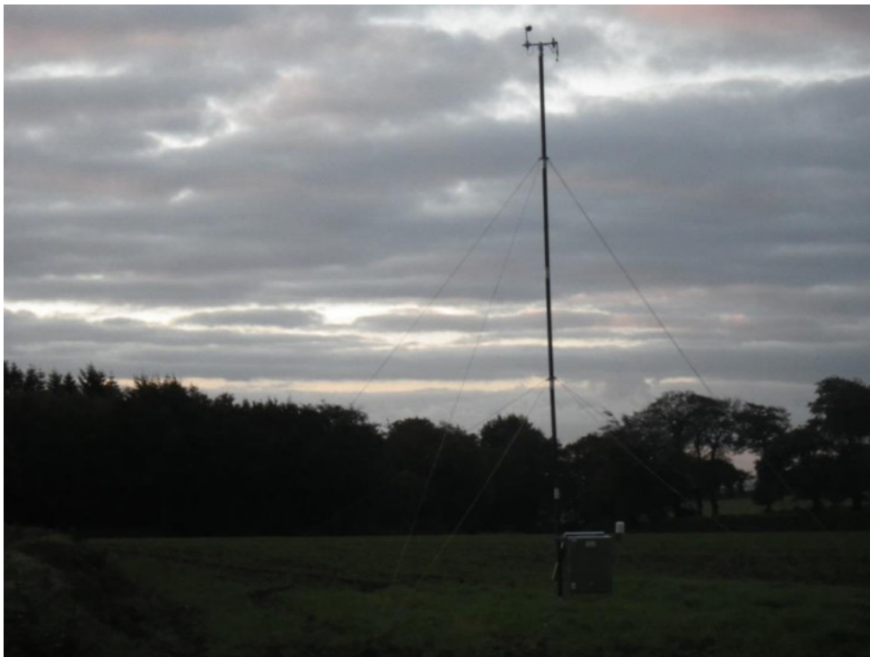
Aperçu du dispositif d'enregistrement sur mât de 10m
