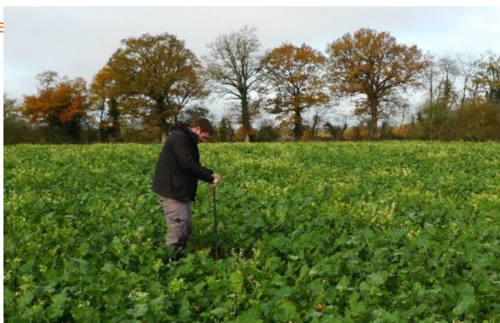
Prélèvement à l'aide d'une tarière pédologique - Calidris
