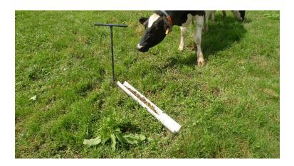
Sur le carottage du point de prélèvement 15, les traces d'oxydoréductions débutent dès 20 cm et s'intensifient fortement à partir de 40 cm.
