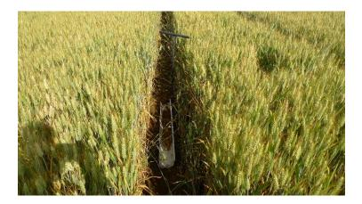
Sur le carottage du point de prélèvement 3, on ne retrouve aucune trace d'oxydoréduction à moins de 60 centimètres.
