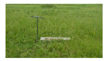
Sur le carottage du point de prélèvement 9, on ne retrouve aucune trace d'oxydoréduction à moins de 60 centimètres.
