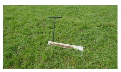
Sur le carottage du point de prélèvement 14, les traces d'oxydoréductions débutent vers 40 cm et s'intensifient fortement dès 50 cm.
