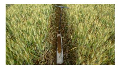
Sur le carottage du point de prélèvement 5, on ne retrouve aucune trace d'oxydoréduction à moins de 50 centimètres.
