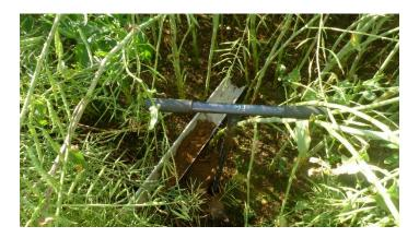
Sur le carottage du point de prélèvement 1, on ne retrouve aucune trace d'oxydoréduction jusqu'à 50 centimètres.
