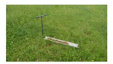
Sur le carottage du point de prélèvement 8, on ne retrouve aucune trace d'oxydoréduction à moins de 60 centimètres.
