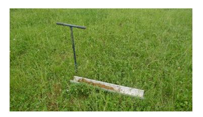
Sur le carottage du point de prélèvement 6, on ne retrouve aucune trace d'oxydoréduction à moins de 50 centimètres.
