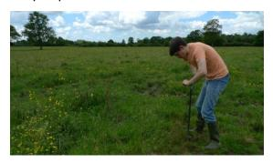
à l'aide d'une tarière pédologique. Cet outil rudimentaire permet de prélever de manière graduée des échantillons de sol pour y rechercher des traces d'oxydoréduction. Chaque prélèvement a été localisé, afin de permettre un report précis de ces derniers sur les fonds de carte.
