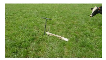
Sur le carottage du point de prélèvement 13, les traces d'oxydoréductions débutent vers 40 cm et s'intensifient fortement dès 50 cm.
