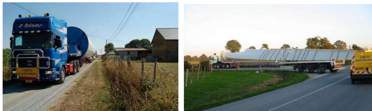
Photo 123 : le transport des éléments d'une éolienne
