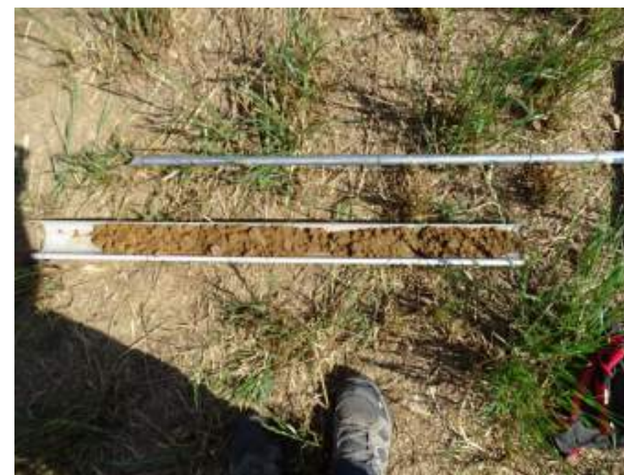
Figure 8 : Exemple de sondage pédologique, (AEPE-Ginko, photothèque)
