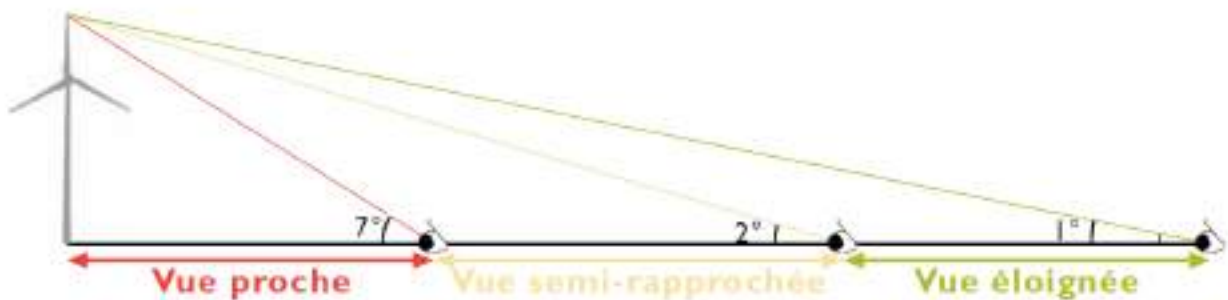
Figure 2 : La notion de « taille apparente » pour évaluer l'impact visuel du parc éolien
