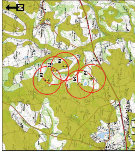
Figure 7 : Carte du risque de mouvement de terrain sur la zone du projet
