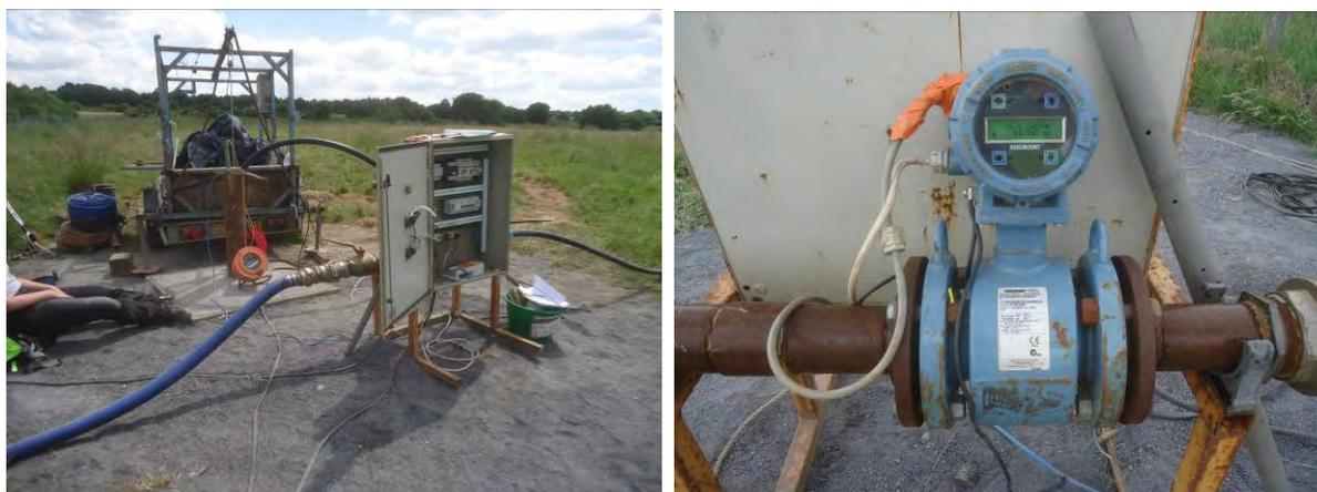
Illustration de l'équipement de pompage du piézomètre PzA (tube guide-sonde, armoire électrique raccordée au groupe électrogène côté fosse 3, conduite de refoulement) et du débitmètre (à droite).
