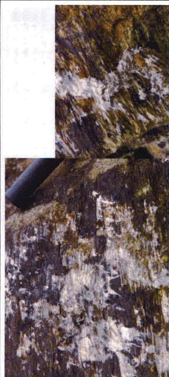
Figure 4 : Exemples de plans porteurs de cristallisations fibreuses d'amphibole verte. Ces fibres sont blanches par l'altération et dissocées en fibrilles asbestiformes.
