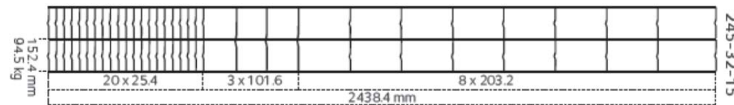
Figure 24 : Clôture grande faune à mailles progressives de type 245/32/15
