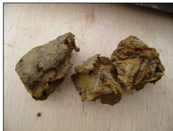
Illustrations de sondages à la tarière réalisés avec la présence de trace d'oxydo-réduction permettant d'identifier des sols hydromorphes (photos non prises sur site)
