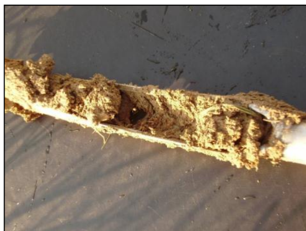
Illustrations de sondages à la tarière réalisés avec la présence de trace d'oxydo-réduction permettant d'identifier des sols hydromorphes (photos non prises sur site)
