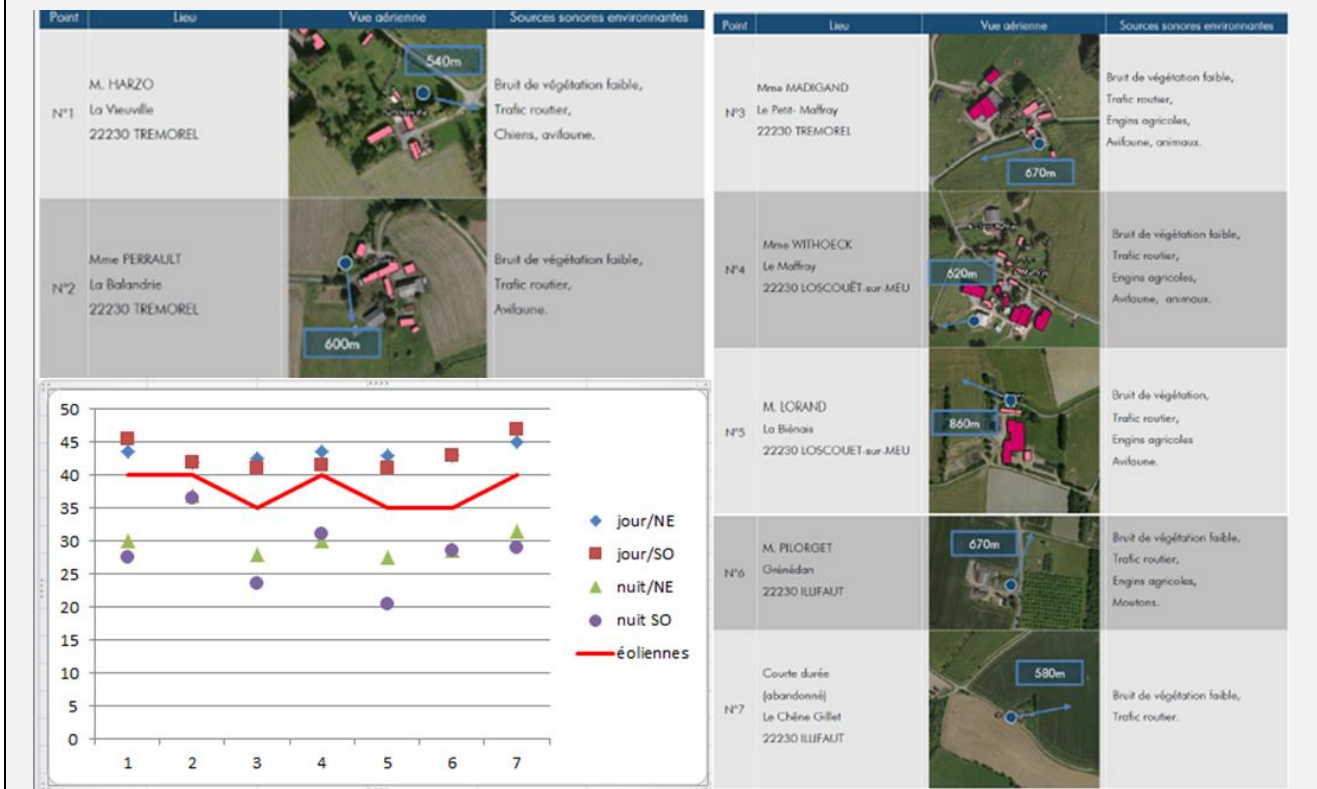
Figure 24 : localisation des points de mesures acoustiques (source dossier) et estimation du niveau de bruit des éoliennes au regard des bruits ambiants estimés
