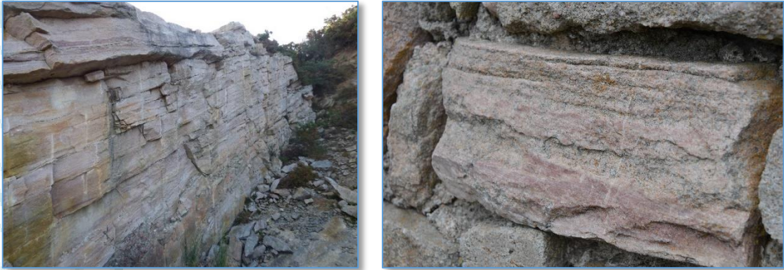
Fig. 18 : Vue sur le gisement exploité à gauche, roche en place sur la carrière, à droite, zoom sur un bloc de maison d'Erquy
