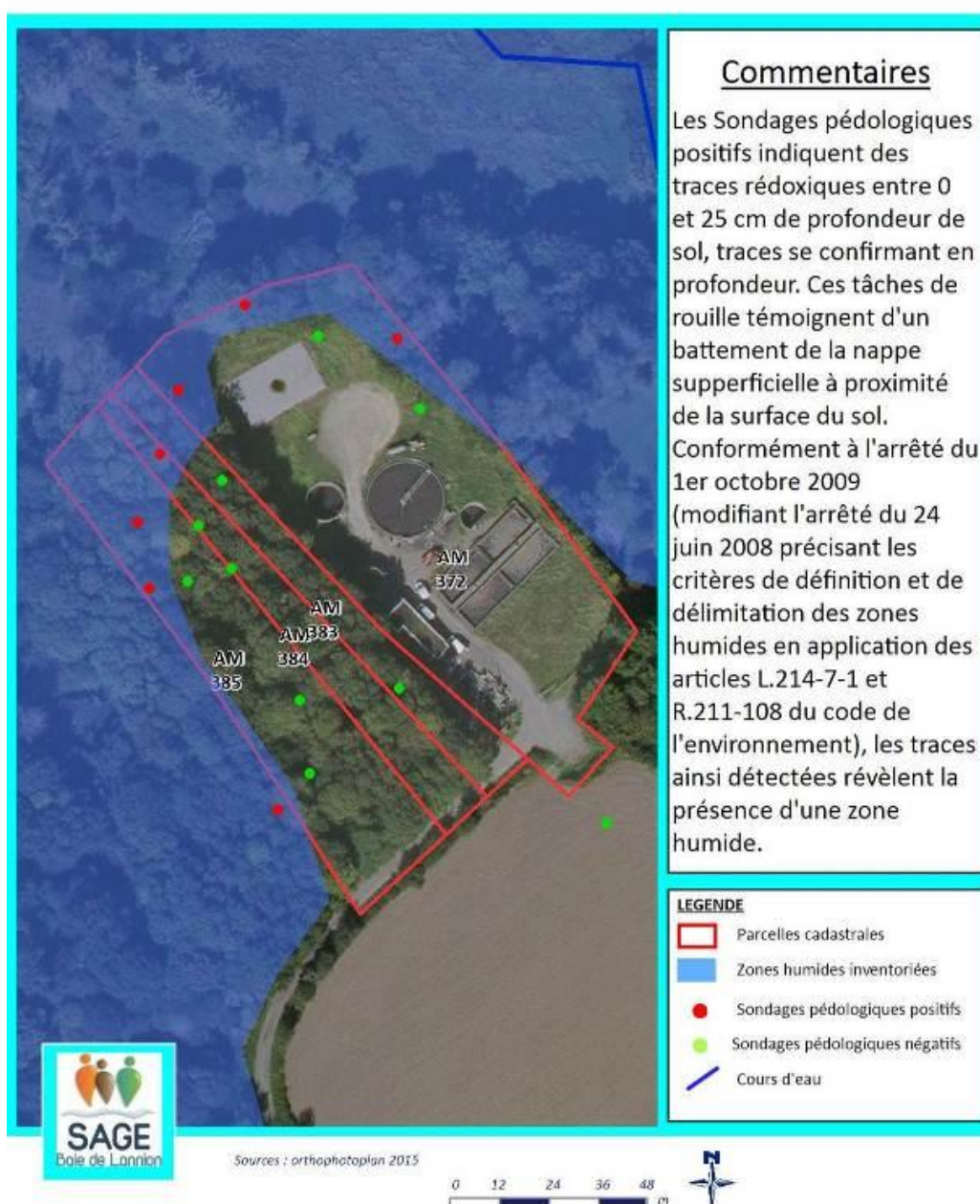
Figure 6 : Délimitation des zones humides en limite du projet (source : SAGE baie de Lannion)
