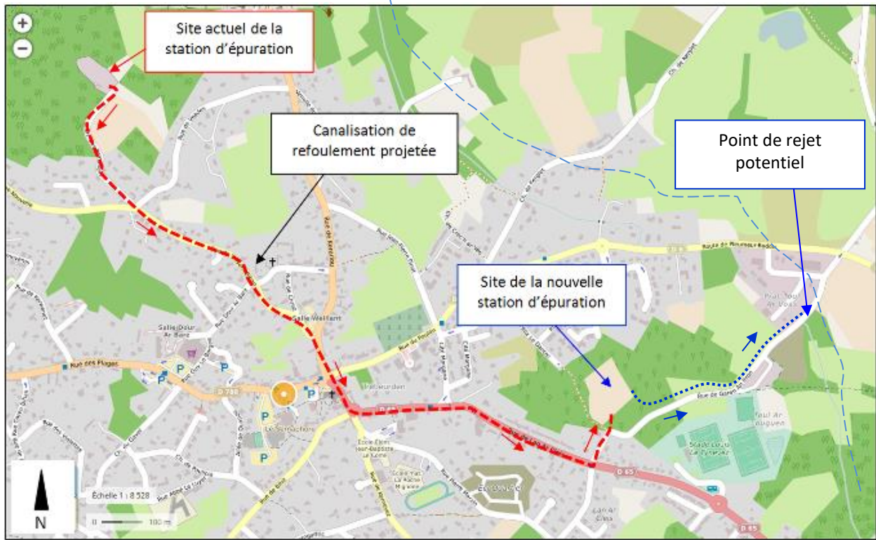
Figure 27 : Schéma de principe du transfert des eaux traitées vers le point de rejet actuel.
